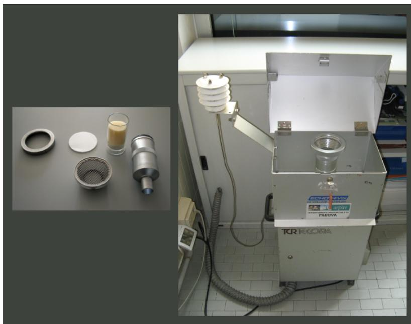
Figura 1.4: a sinistra: elementi della testa di prelievo (filtro bianco PTS con relativa ghiera e testa retinata di alloggiamento, e PUF nel contenitore in vetro silanizzato e relativa testa cilindrica di alloggiamento); a destra: il campionatore ad alto flusso, con alloggiata testa di prelievo, sensore termico esterno e tubo di scarico dell'aria.
