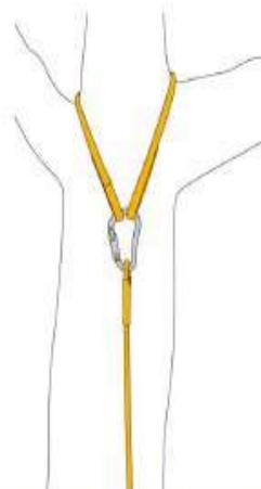
Fig. 5 - Ancoraggio della fune con dispositivo passante
