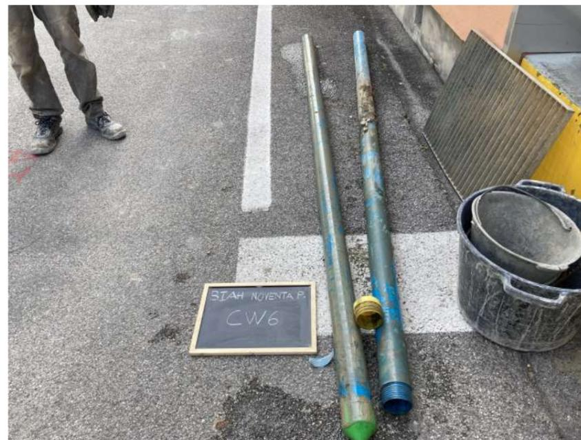
Piezometro estratto BH6 (un tubo da 1 metro cieco e uno da 3 metri fessurato) / Removed Monitoring well BH6 (a 1m-long riser and a 3m-long screen)
